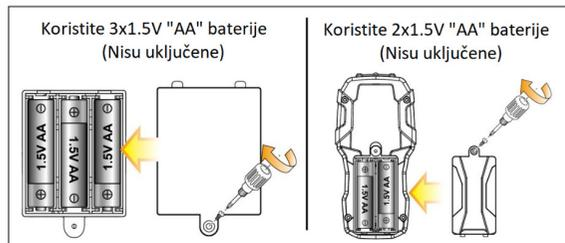
Otvorite poklopac spremnika baterija robota i umetnite 3 kom „AA“, a za daljinski upravljač umetnite 2 kom „AA“ baterije prema označenom polaritetu.
